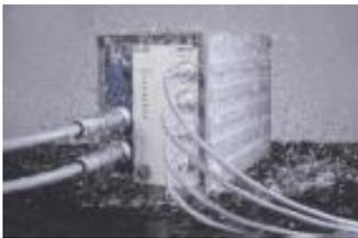
Класс защиты IP65 позволяет устанавливать на тестируемом объекте
